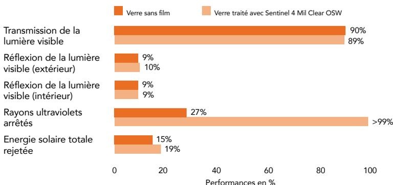
Les résultats reflètent une installation à l'extérieur d'un simple vitrage transparent de 4 mm d'épaisseur et d'un double vitrage transparent de 4mm+4mm
