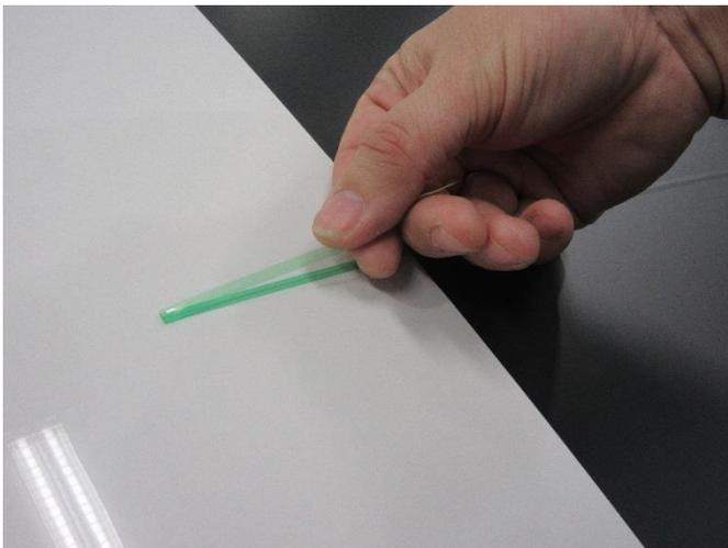
Presser fermement avec le pouce au niveau de la pliure en couvrant le ruban sur 1 cm minimum. Saisir fermement l'extrémité du ruban entre le pouce et l'index. Démarrer en plaçant de part et d'autre les deux pouces espacés d'environ 1 cm. Tirer un coup sec pour libérer le filament de coupe du ruban support.
