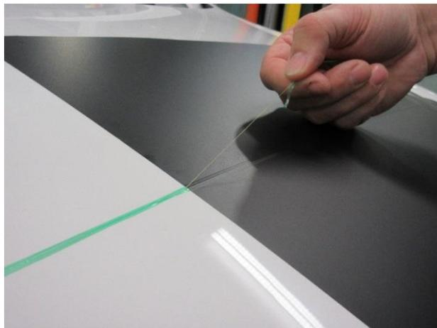
Rabattre le filament de coupe au-dessus du film. Sur le bord du film presser avec le pouce simultanément le filament de coupe et le film. Tirer doucement pour amorcer la découpe en continuant à tirer le filament en arrière et non vers le haut.
